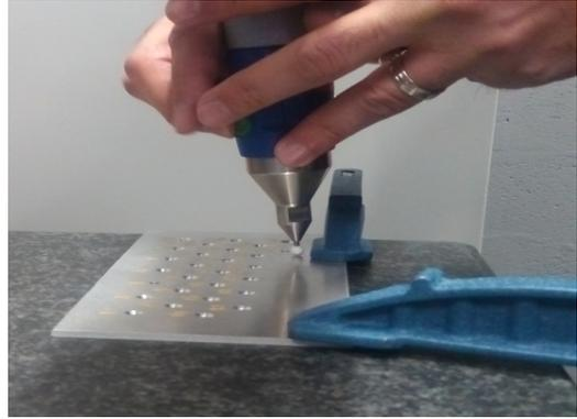
图7 钻孔试板检测
