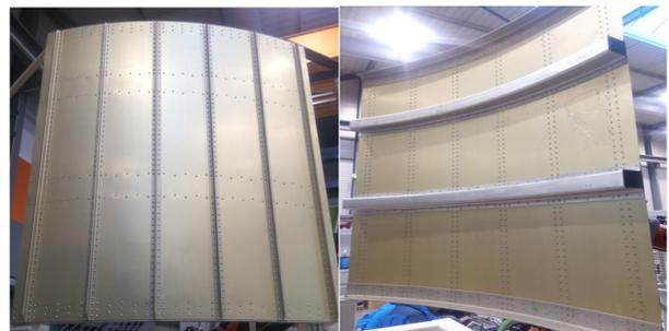
图10 铆接工艺试验样件
