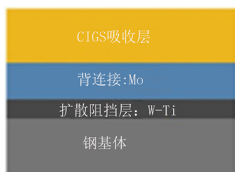
图6 CIGS薄膜太阳能电池结构示意图
