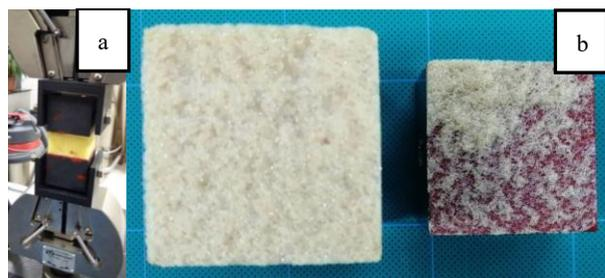
图8 拉伸性能测试及泡沫典型拉伸破坏形式
