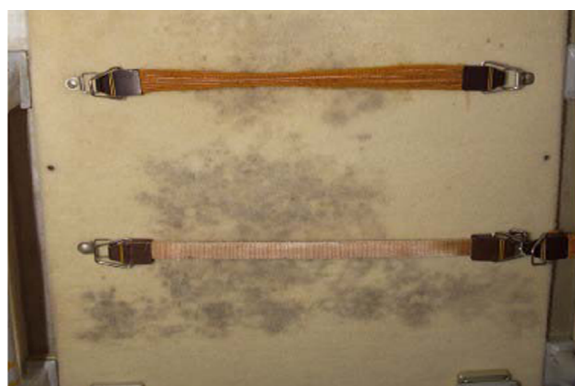
图12 空间站上FGB纤维板受到霉菌侵蚀污染的照片 [55]
