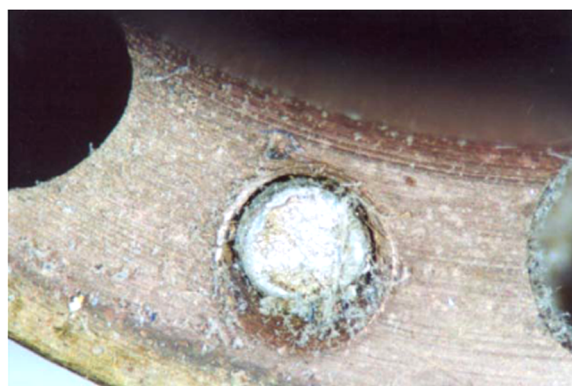
图11 俄罗斯空间站烟感探测器真菌生长情况 [54]
