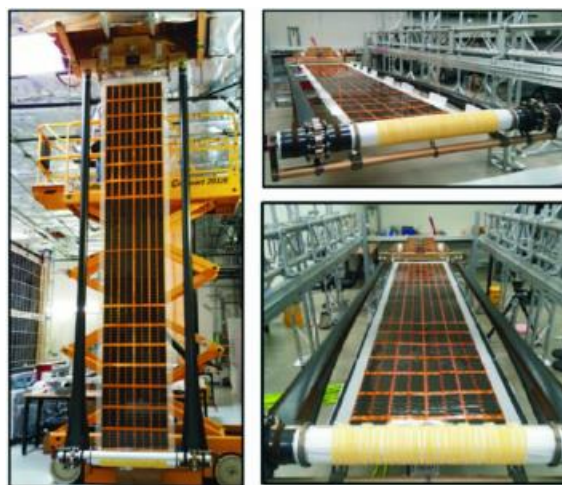
图14 ROSA 薄膜太阳能电池阵地面展开状态 [63]
