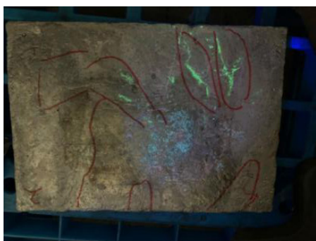
图1 试板铸件表面微观缺陷荧光检测结果
