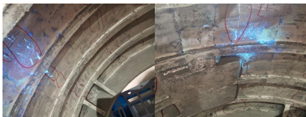
图3 铸件荧光检测结果
