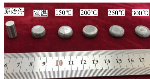
图1 室温及高温压缩试样宏观形貌
