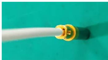
图8 改变位置器压接出线端变形
