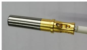
图7 端子压接后观察孔变形
