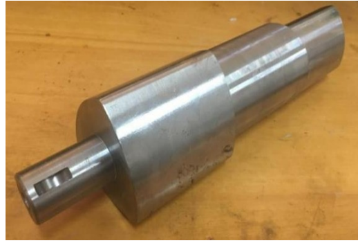
图3 三弧段非圆等距型面轴
