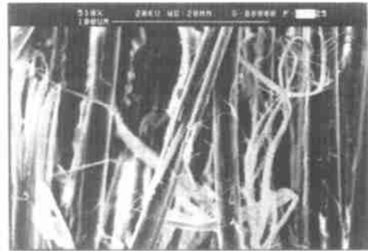
(a) 辐照前断口的纤维劈裂
