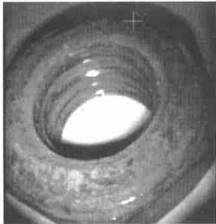
图9 铜锣帽高度的测量 点一线测量模式 实际尺寸=8.20 mm;测量尺寸=8.42 mm。
