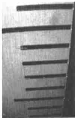
图6 测量标尺刻度点一点测量模式 实际尺寸=2.0 mm;测量尺寸=2.02 mm。
