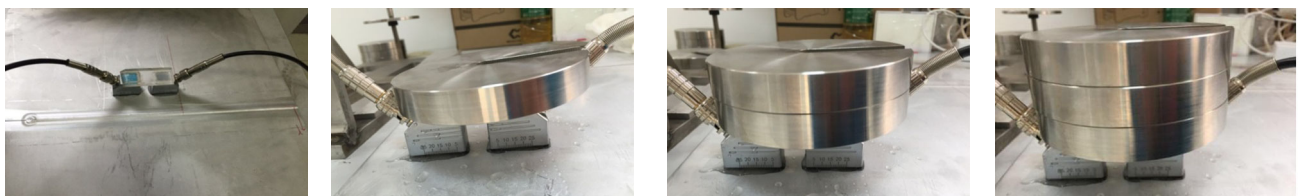
图5 LCR波换能器上放置压块操作图
