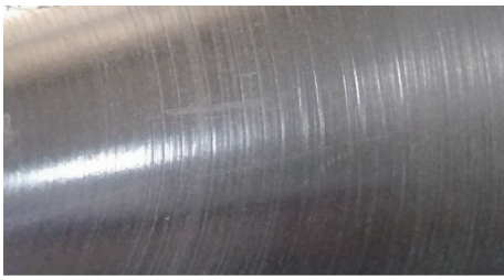
图8 PEEK/450CA30 试件加工表面
