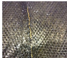
图8 固化后的反射面上蜂窝芯拼接
