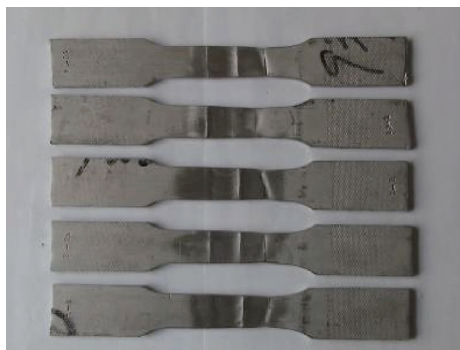
图 15 铝铜系/铝镁系异种铝合金接头拉伸试样断裂位置 Fig. 15 Fracture positions of Al-Cu/Al-Mg dissimilar aluminum alloy tensile specimen
