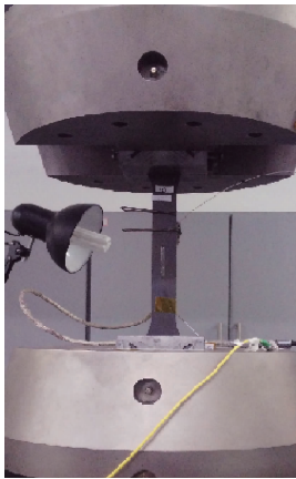
图 3 安装有引伸计的试验件 Fig. 3 Sample installed extensometer
