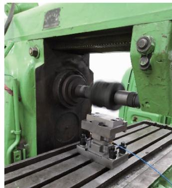
图 13 冷滚打机床
