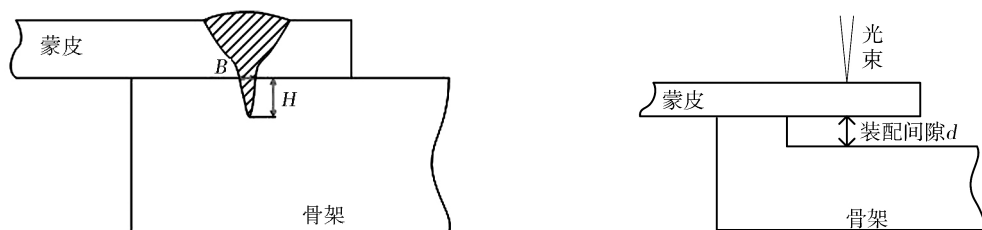
图 2 T 型接头骨架熔宽及骨架熔深示意图
