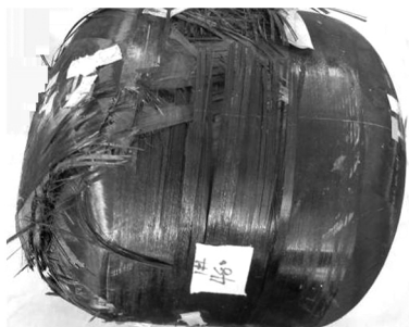
图 6 量化等强度增强 Φ480 mm 壳体水压试验残骸
