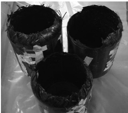
图 1 第一批 \Phi 150 mm 壳体水压残骸
