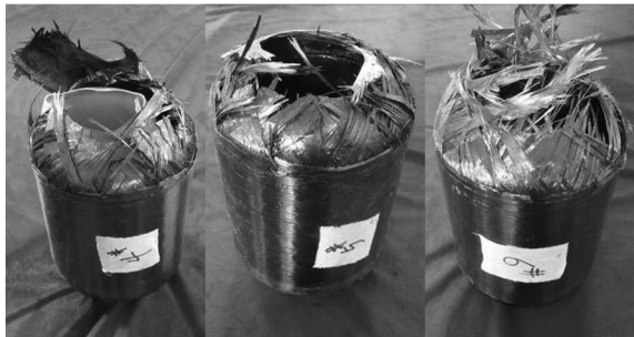
图 2 第二批 \Phi 150 mm 壳体水压残骸
