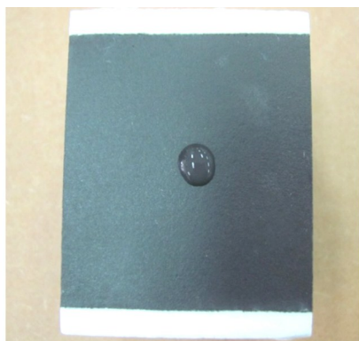
图7 含涂层刚性隔热瓦防水效果
