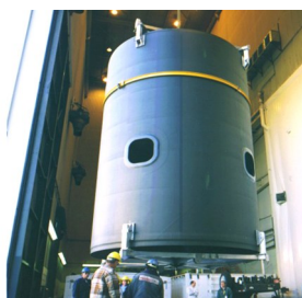
图9 Delta-3 运载火箭 VBO 复合材料级间段
