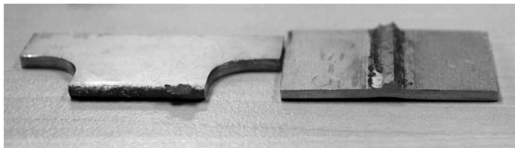
图 8 2524/7150 T 型接头 z 向拉伸断裂宏观形貌
