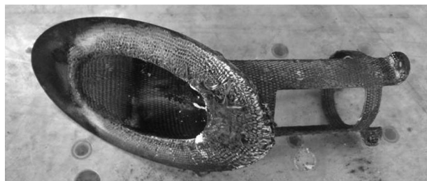
图 12 试验后的结构件烧蚀状态
