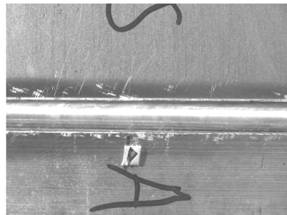
(d) 焊缝表面成型
