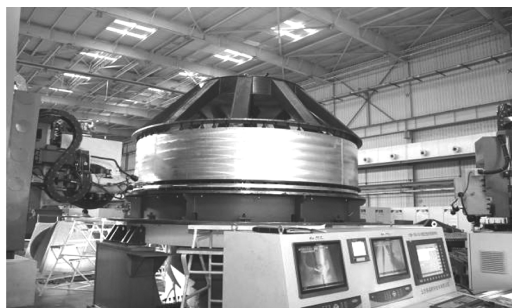
(c)、(d) 安装短壳及装配精度保障工装
