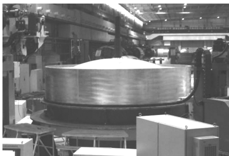
(c)、(d) 安装短壳及装配精度保障工装
