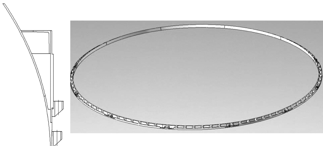
图10 用于保证锁底环缝装配精度及保障叉形环大端周长的分体式刚性紧固装置
