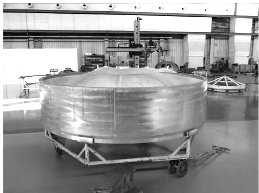
图 15 锁底环缝试验件整体形貌
