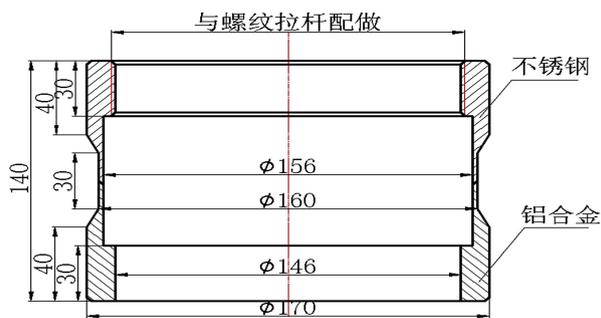
图 1 拉伸试样示意图
