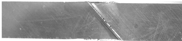
图 11 拉伸破损图片
