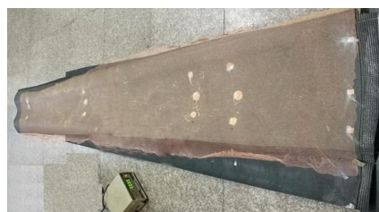
图3 尾梁全尺寸模拟试验件
