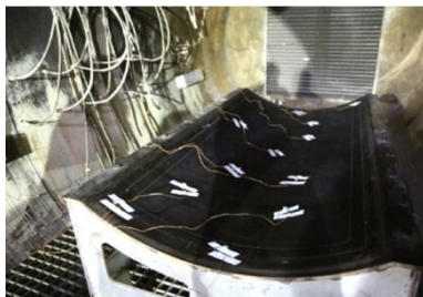
图6 型板表面热电偶布置位置
