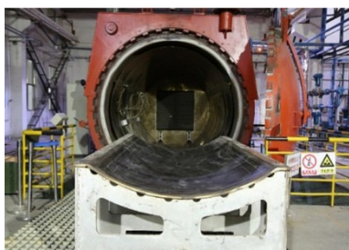
图5 验证实验模具及热压罐
