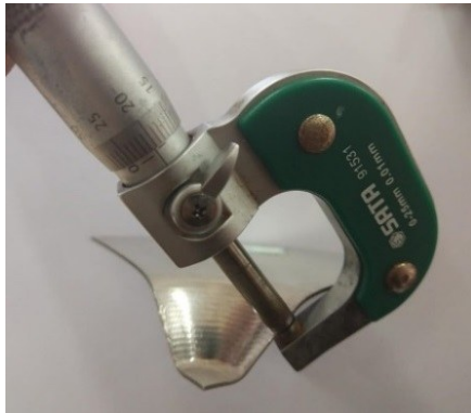
图10 千分尺测量壁厚
