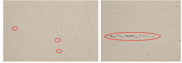
(a) 靠近表面区域硫化物 (b) 心部区域硫化物 图3 非金属夹杂物形貌
