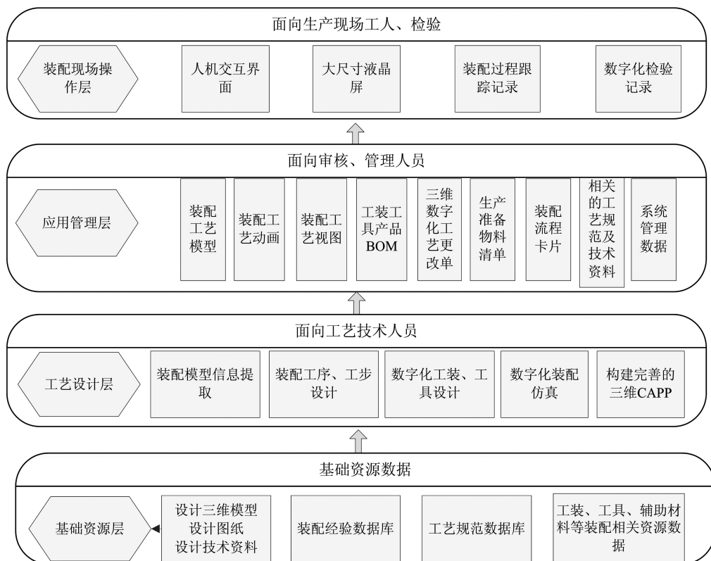
图3 数字化装配结构设计图
