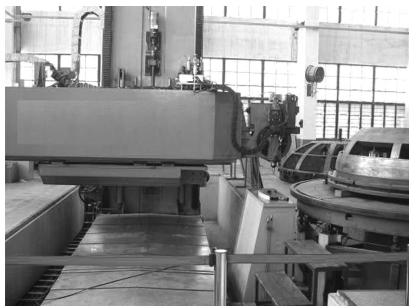
图2 数控悬臂式搅拌摩擦焊设备及夹层共底焊接工装
