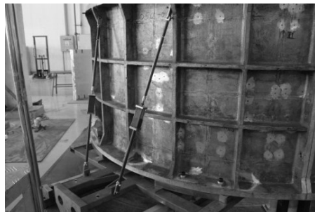
图10 脱模工装与筒段成型模连接后状态图
