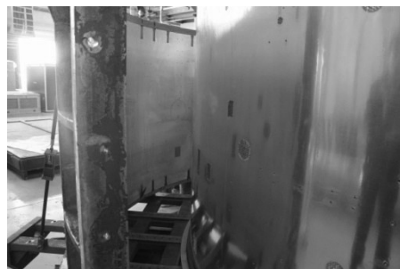
图11 筒段产品与筒段成型模在脱模工装作用下分离
