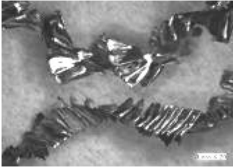
进给量 33 \mu\text{m/r} ( 30 \text{ mm/min} ); 轴向力 660.5 \text{ N}
