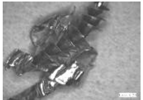
进给量 129 μm/r(90 mm/min);轴向力 960.0 N
