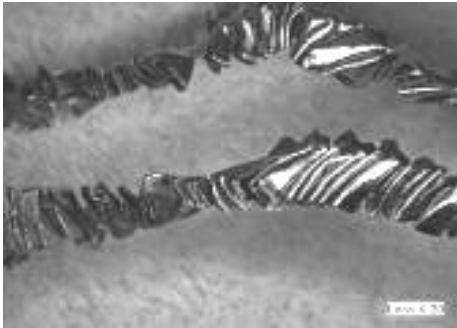
进给量 56 \mu\text{m/r} ( 50 \text{ mm/min} ); 轴向力 735.7 \text{ N}
