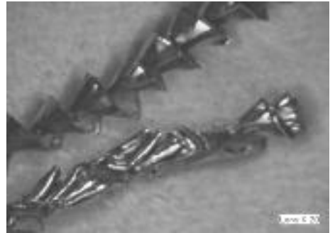
进给量 71 μm/r(50 mm/min);轴向力 801.9 N
