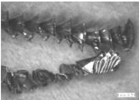
进给量 100 \mu\text{m/r} ( 90 \text{ mm/min} ); 轴向力 805.1 \text{ N}
