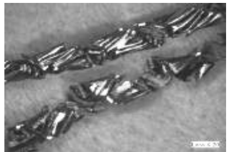
64 \mu\text{m/r} ( 70 \text{ mm/min} ); 轴向力 707.3 \text{ N}
