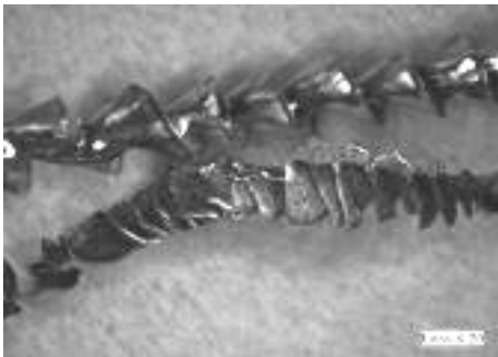
进给量 78 \mu\text{m/r} ( 70 \text{ mm/min} ); 轴向力 776.4 \text{ N}
