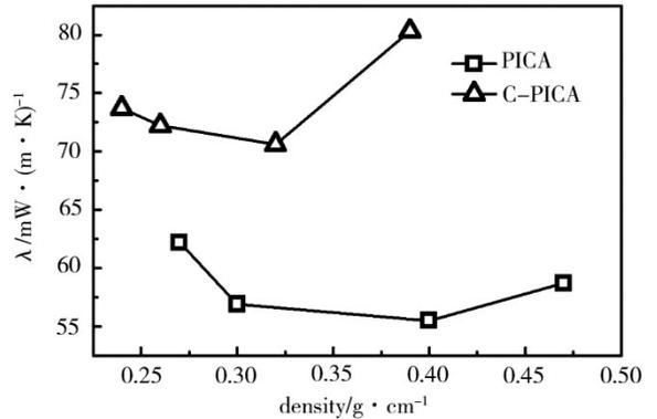
图6 PICA 和 C-PICA 的热导率
