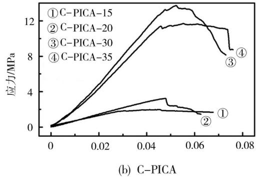
图5 PICA 和 C-PICA 弯曲应力—应变曲线图
