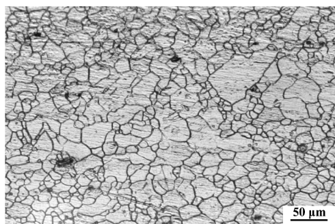
图 1 AZ31 热处理后的微观组织
