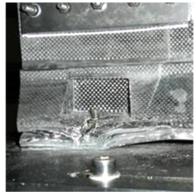
图 7 试验件破坏情况
