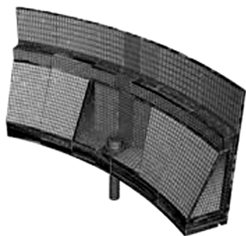
图2 L型接头连接及其装配件有限元模型
