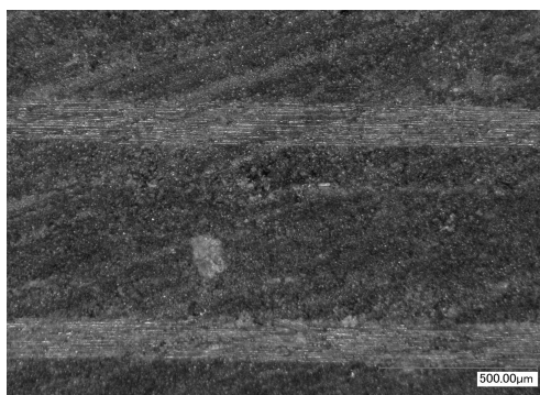
(b) 方孔内表面微观照片
