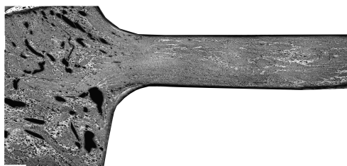
图5 远离裂纹区域金相形貌(白色块状区为树脂)
