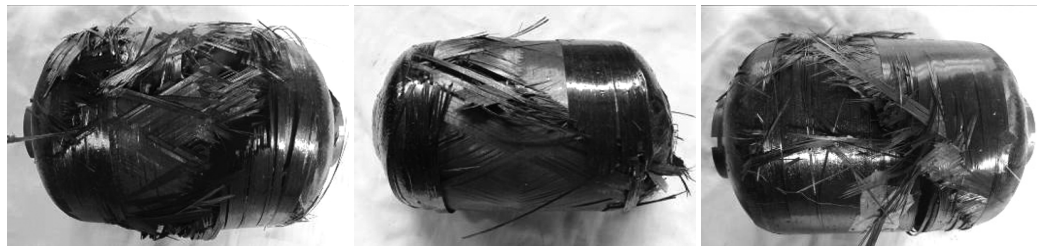
图4 接头优化后 T800HB 碳纤维 \Phi 150 mm 容器水压破坏形貌
