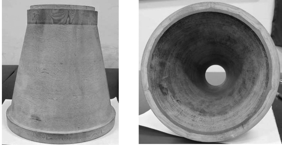
图 9 \Phi 315 mm 发动机喷管斜向缠绕扩张段
