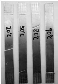
图3 5052 铝合金板材在四个温度下的破坏模式
