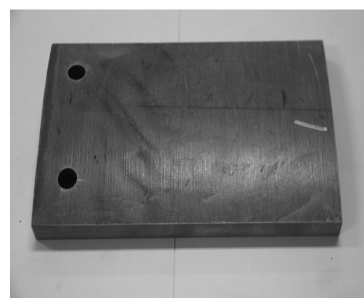
(a) 玻璃纤维复合材料平板试验件
