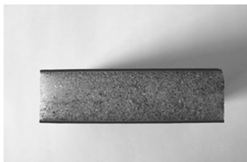
图3 平压试样破坏模式
