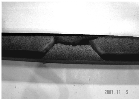
图5 弯曲试样破坏模式
