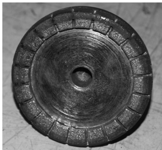
(a) 干法加工 100 件后磨头照片
