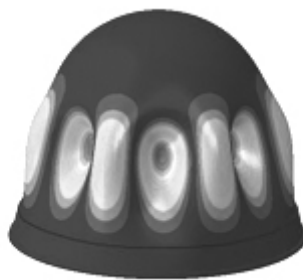
图5 复合材料球锥组合体非线性后屈曲的外压失稳波
