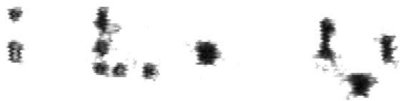
图6 人工粘贴缺陷C扫描超声检测图像
