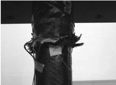
图6 复合材料杆件压缩破坏模式
