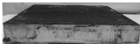
图5 改性纤维/酚醛风洞测试后侧面
