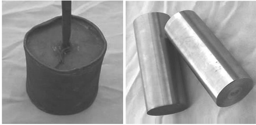
图 3 HIP 后粉末冶金 Ti-6Al-4V 试样包套及材料
