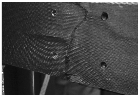
图4 原材料性质差异产生的破坏
